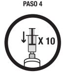
Usar una jeringa de 50 ml para empujar agua purificada por la punta del filtro, de tal forma que fluya en el sentido contrario de las fibras. Repetir 10 veces para retrolavado.
